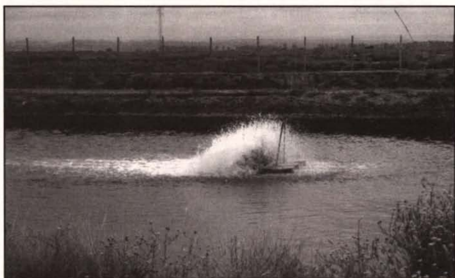
Foto 24 - Arejador em funcionamento numa unidade de piscicultura intensiva da ilha da Morraceira. A turbidez e a densidade de peixes no tanque obrigam à utilização de meios artificiais de oxigenação (05/11/97).
