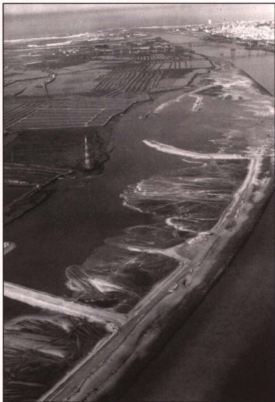
Foto 13 - Aterro de regularização da margem norte da ilha da Morraceira, com destruição do sapal original e enrocamento confinante com o Braço Norte (05/11/1994).
