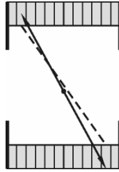
Fig. 6.15 - Ilustração do efeito de profundidade de interacção (DOI). Se um fóton atingir um cristal obliquamente, pode penetrar em cristais vizinhos, fazendo com que o sistema conte uma coincidência numa LOR com direcção errada (LOR a tracejado).
