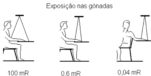
Fig. 13.6 – Exposição nas gónadas para diversas posições de um paciente numa radiografia da mão.
