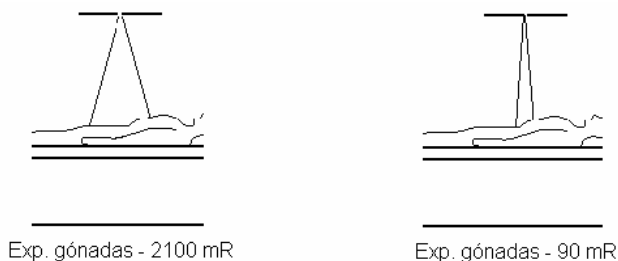
Fig. 13.5 – A utilização de feixes com áreas desnecessariamente elevadas pode aumentar consideravelmente a dose nas gónadas.
