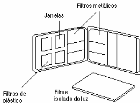
Fig. 5.28 – Caixa de plástico «badge» e filme utilizados pelos trabalhadores com radiações ionizantes.
