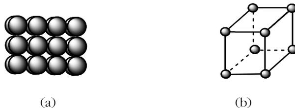
Figura 7.11 a) Empacotamento em quadrícula regular; b) Célula unitária primitiva do sistema cúbico.
