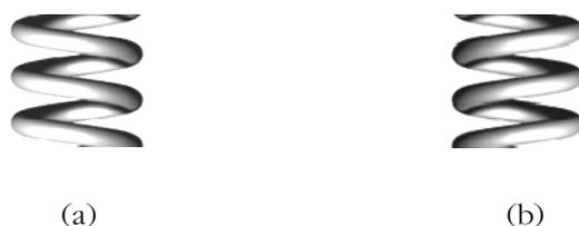
Figura 4.7 Representação esquemática dum hélice direita (a) e dum hélice esquerda (b).
