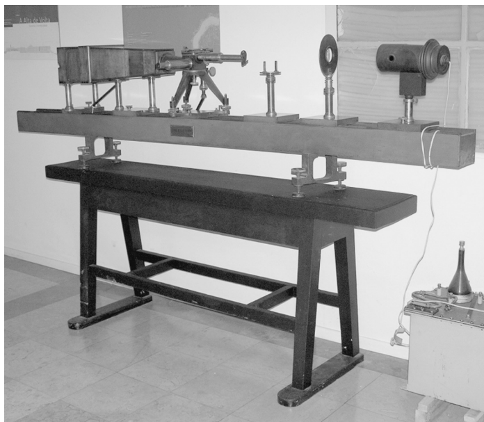
Fig. 39 - Microscópio metalográfico Le Châtelier (1906). Peça proveniente do Laboratório Nacional de Engenharia Civil. Lisboa (Arquivo MNCT)
