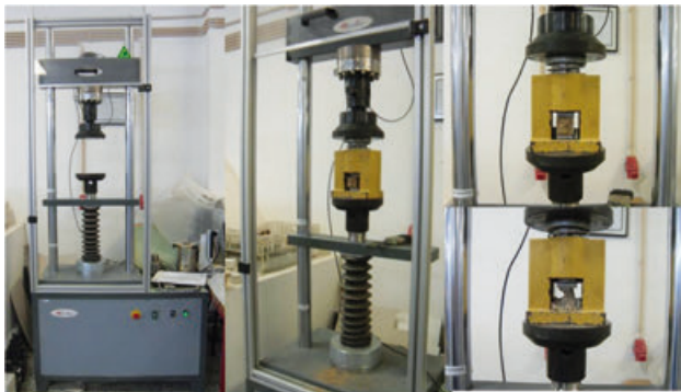
Fig. 5 – Equipamento MicroTest modelo PB/20 onde foi realizado o ensaio de resistência à compressão uniaxial.
