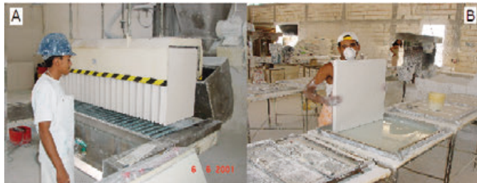
Fig. 6 – Confecção de pré-moldados de gesso: (A) blocos e (B) placas.
