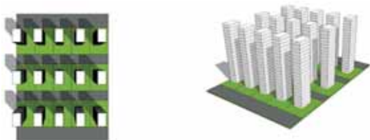
Fig. 20 - Na mesma zona, para se atingir o maior IAT e o gabarito máximo de 18 pavimentos, ocupa-se apenas 17%, situação que também só se torna atraente para o proprietário quanto maior o lote ou gleba, induzindo-se assim o modelo de condomínios fechados.
