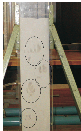
Fig. 11 - Bolhas de ar a ascenderem num leito fluidizado.
