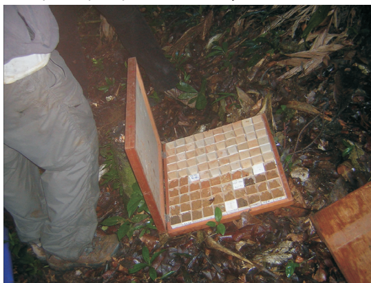
Fig. 4 - Pedocomparador com amostras coletadas a cada 10cm.
