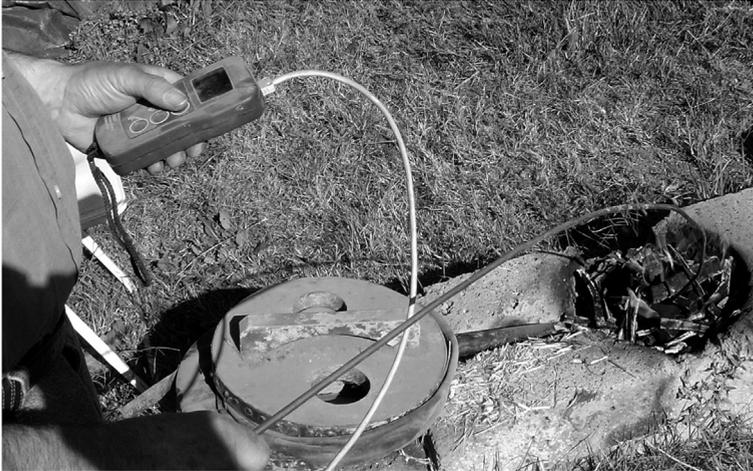
FIG. 4 – Misurazione con termocoppia delle temperature raggiunte in un esperimento per l'estrazione dell'antimonio (Blera – Antiquitates 2011) (Foto C. Giardino).
