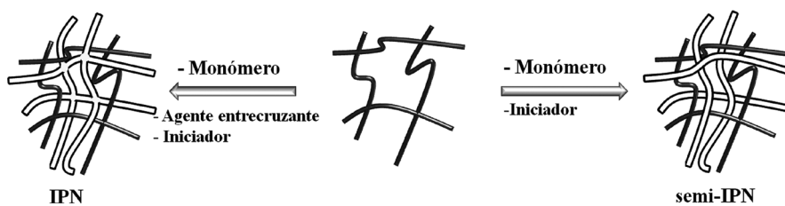
Figura 12.8. Esquema de formación de una semi-IPN y una IPN.
