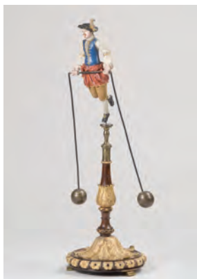
Figura 7 – Um exemplar emblemático transferido do Colégio dos Nobres e ainda em exposição no Gabinete de Física é o equilibrista (FIS.0021), um instrumento de demonstração do centro de gravidade de um corpo, na forma de um equilibrista trajado à época (fotografia de José Meneses).
