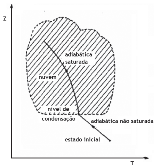
Fig. 10 - Movimento ascendente de ar na atmosfera (adaptado de V. Iribarne e H. R. Cho, 1980).
