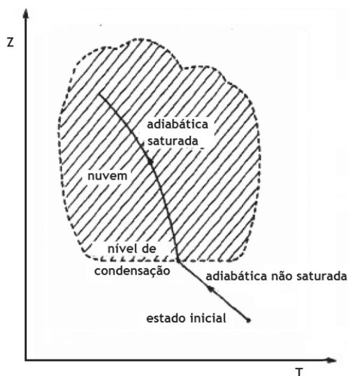
**Fig. 10** - Movimento ascendente de ar na atmosfera (adaptado de V. Iribarne e H. R. Cho, 1980).
