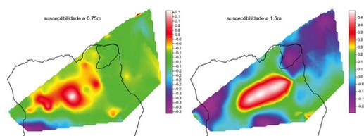
Figura 7- Distribuição espacial da suscetibilidade magnética, estimada por interpolação dos valores medidos sobre os perfis assinalados na Fig. 2. Esquerda: suscetibilidade para a profundidade de 0,75 m. Direita: suscetibilidade para 1,5 m.
