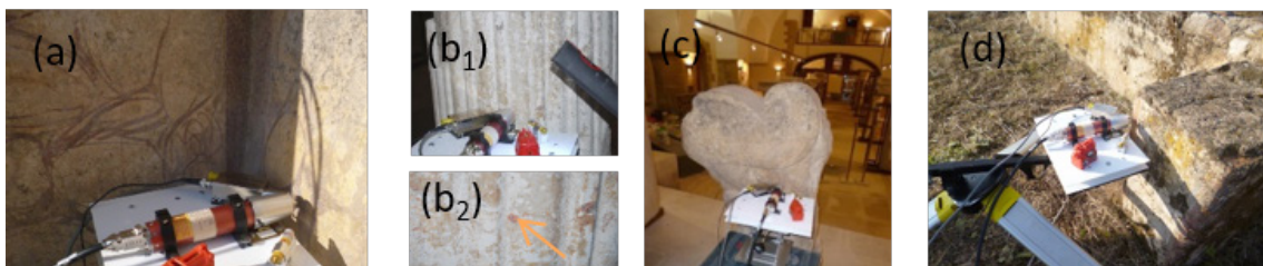
Figura 3- Elementos decorativos del TRM (a-c) y VRLM (d) analizados mediante fluorescencia de rayos X: (a) Frente escénico, (b) columna, (c) esfinge y (d) muros.
