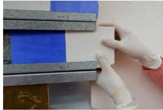
Figura 6- Colocación de las probetas de yeso en el bastidor metálico para su envejecimiento exterior.
