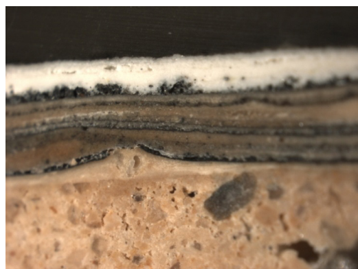
Figura 7- Secuencia de estratos de la muestra C4 (x40), en la que se observa la irregularidad de las capas.
