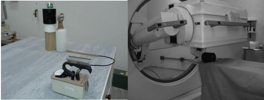
Figura 1. Calibração de detector de contaminação de superfície (direita) e Gama-câmara (esquerda) utilizando simulador de tireoide-pescoço do IRD
