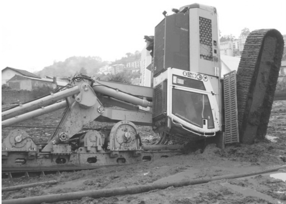
Figura 3.9. Um acidente com uma máquina utilizada na execução de estacas. (Foto do Autor).
