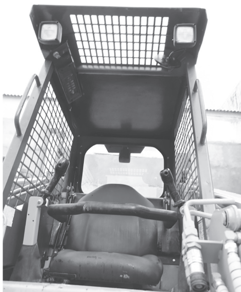
Figura 4.6. Entre muitos outros aspetos o Decreto-Lei n.º 103/2008, de 24 de junho, impõe a obrigatoriedade da existência de estruturas de proteção do operador das máquinas contra a queda de objetos (FOPS – Falling-Object Protective Structures ) e contra o capotamento (ROPS – Roll-Over Protective Structures ). (Foto do Autor)
