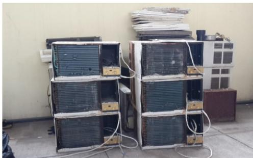
Ar condicionados domésticos retirados após uso. Devido ao grande esforço das máquinas e ao funcionamento contínuo durante todo o dia, as mesmas não resistiam por muito tempo (um e meio a dois anos no máximo)
