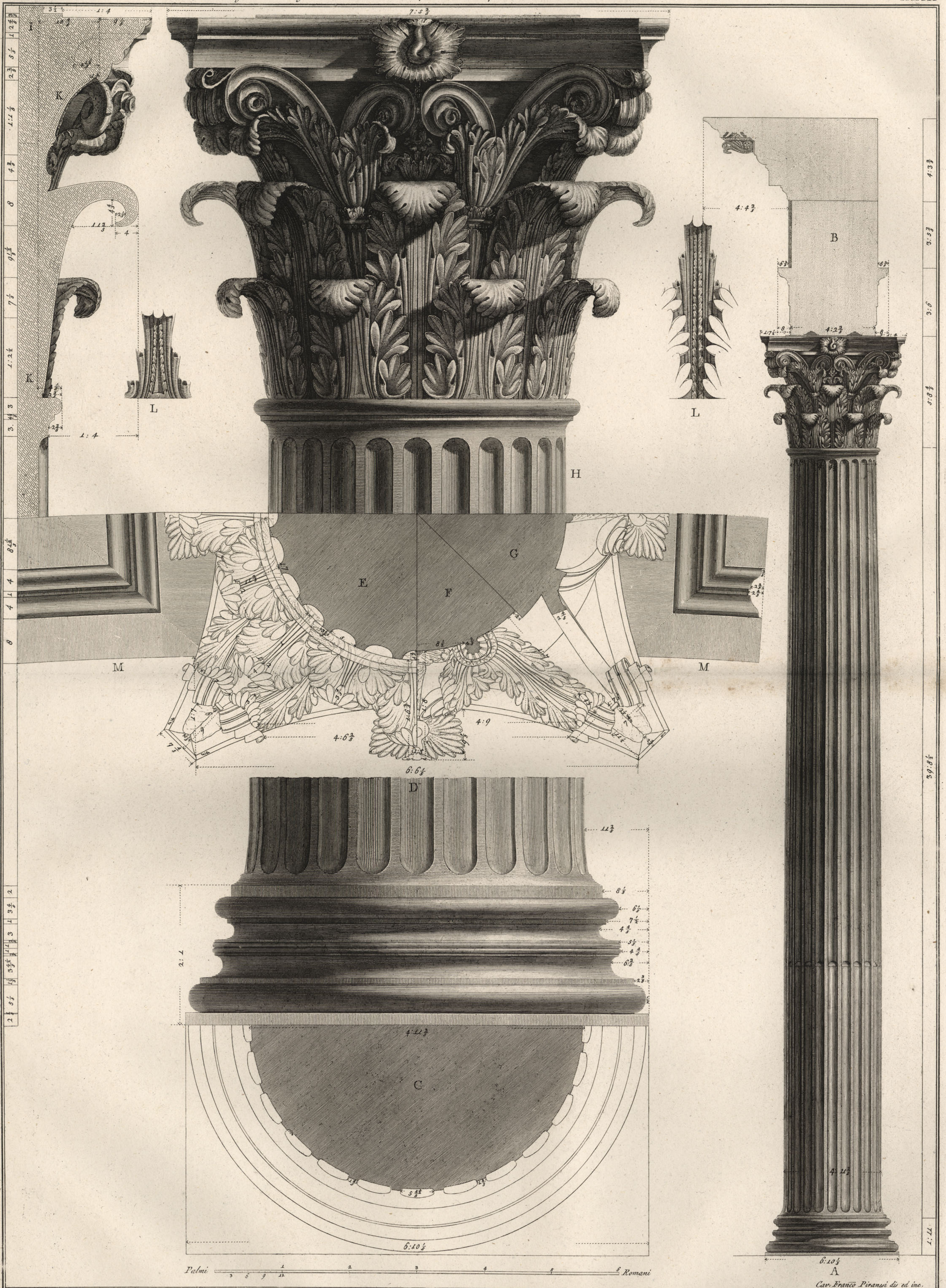
A. Colonna dell'ordine interiore. B. Profilo del suo intavolamento, o sia architrave, fregio, e cornice. C. Pianta della metà di una delle colonne, con sua base tagliata al di sopra del imoscapo. D. Porzione della detta colonna tagliata dove si è formata la pianta sottile. E. Pianta di un quarto del capitello della suddetta colonna tagliata al di sotto del sommoscapo. F. Pianta della metà di un quarto del detto capitello tagliata al di sotto delle foglie de' caulicoli. G. Pianta dell'altra porzione convessile del capitello tagliata al di sopra delle foglie de' caulicoli. H. Capitello con porzione di colonna tagliata dove si è formata la pianta E. I. Spaccato del capitello sulla linea di mezzo. K. Profilo della campana del detto capitello. Queste misure furono prese nel sito segnato in pianta. L. Molti capitelli differiscono da questo avendo tanto il primo quanto il secondo ordine delle foglie, le costole di mezzo intagliate come si dimostra in I. M. Soffitto del architrave, che passa sopra le colonne.
