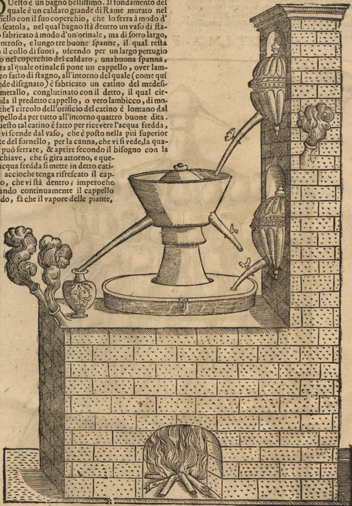
che vi sale, si condensano più facilmente, e si convertiscono in acqua. Il che è causa che i distillatori cavino affai più acqua, e migliore. E come questa acqua fredda per il gran caldo del cappello si riscalda, se ne cava fuori per la canna collocata di sotto nella parte destra voltando la chiave, e si riempie di fredda, di cui
