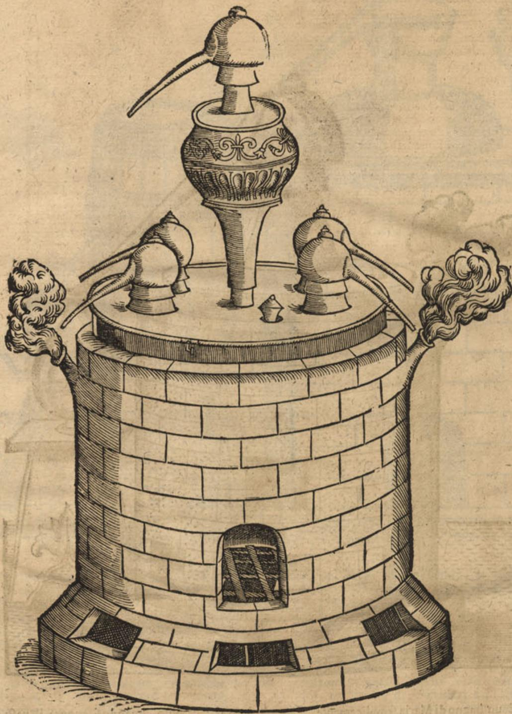
**C**on questo altro bagno si può distillare con cinque lambicchi, quattro cioè, i cui orinali stanno sepolti nell'acqua fino al collo, & uno che stà collocato nel vaso in cima, il quale distilla con il calore del vapore dell'acqua del caldaro, che stà da basso sopra al Fornello, il quale se ne va salendo per la canna, che sostiene il vaso, che è in cima. Possonsi i quattro orinali, che stanno sepolti nel bagno fare così di Vetro, come di Stagno, ò di Rame stagnato, ma i cap-
