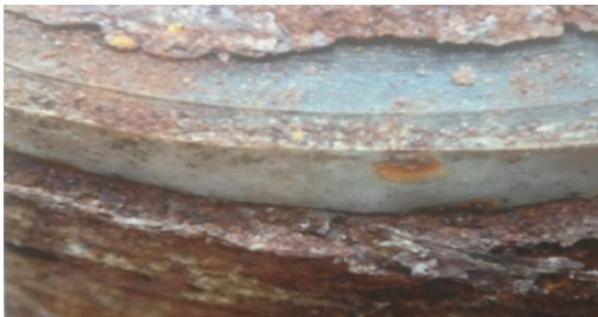
Estado de deterioração de uma caixa metálica de filme, contendo uma fita em avançado estado de decomposição acética (também conhecido por síndrome do vinagre).
