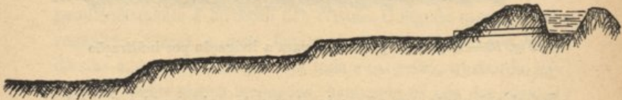
Fig. 20 — Superfície inclinada, preparada em terraços para a irrigação por infiltração
