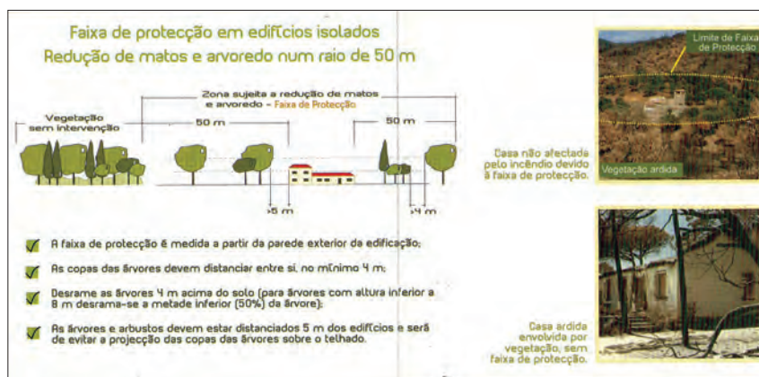
Fig. 13 - Faixa proteção edifícios isolados (Fonte: Instituto de Conservação da Natureza e Florestas (ICNF)).
