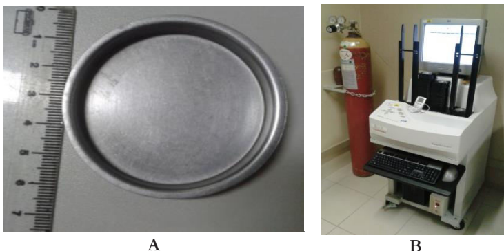
Figura 2. A. Placa inox para evaporação da amostra. B. Contador Proporcional de Fluxo Gasoso
