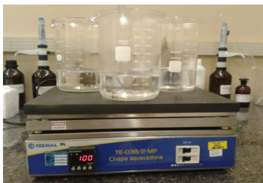
Figura 1. Evaporação das amostras em placa de aquecimento
