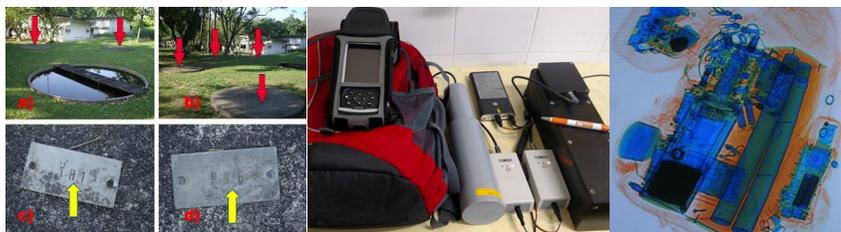
Figura 1. “pads” com concentração conhecida de radionuclídeos naturais, indicados pelas setas vermelhas. As setas amarelas indicam as etiquetas com a identificação de cada “pad”. Ao centro o AT6101C , vulgarmente conhecido como mochila e, na extrema direita, a imagem de Raios X da mochila, evidenciando o cristal de NaI(Tl) e os dois tubos de BF<sub>3</sub> do detetor de nêutrons.
