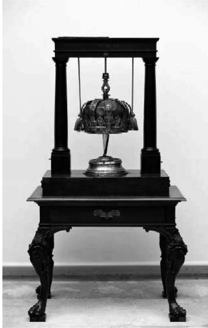
Fig. 11 – O magnete chinês (MCUC | FIS.0290) é um dos objetos emblemáticos do Gabinete de Física e a sua história antecede o Colégio dos Nobres. O instrumento possui uma magnetite oculta numa armação que representa a coroa real. A magnetite foi um presente do Imperador da China a João V, Rei de Portugal em 1722 e o instrumento foi armado por William Dugood (1715–1767), membro da Royal Society que viveu em Portugal (fotografia de José Meneses).
