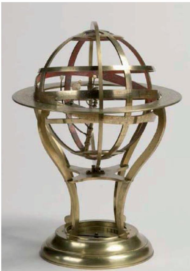
Fig. 14 – Esfera armilar com planetário (MCUC | AST.I.006), construída por George Adams, século XVIII. Trata-se de um modelo da Terra, do Universo e do Sistema Solar. A esfera possui, no seu interior, um planetário com o Sol no centro rodeado pelos planetas conhecidos na época (fotografia de José Meneses)
