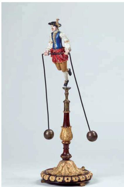
Fig. 9 – Um exemplar emblemático transferido do Colégio dos Nobres em exposição no Gabinete de Física é o equilibrista (MCUC|FIS.0021), um instrumento de demonstração do centro de gravidade de um corpo, na forma de um equilibrista trajado à época (fotografia de José Meneses).
