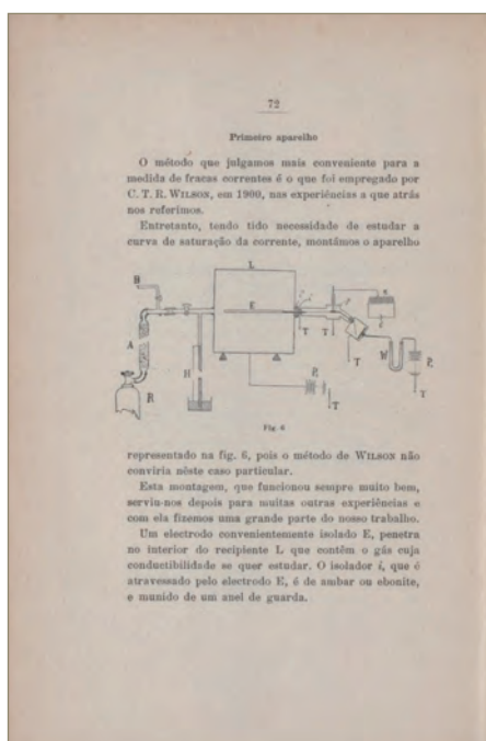
Figura 27 – Ionização dos gases em vaso fechado de Francisco Martins de Souza Nazareth. – Coimbra: Imprensa da Universidade de Coimbra, 1915. À direita está representada primeira experiência de radioactividade realizada em Coimbra. Todo o equipamento foi feito no Laboratório de Física, excepto o eléctrodo de quadrante de Dolezalek.
