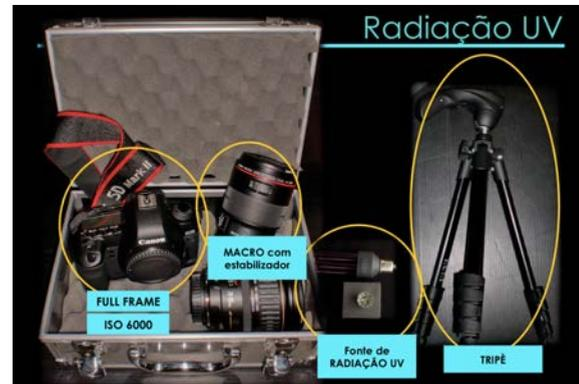
Figura II.19 – Equipamento para o registo em exposição e radiação ultravioleta (UV).
