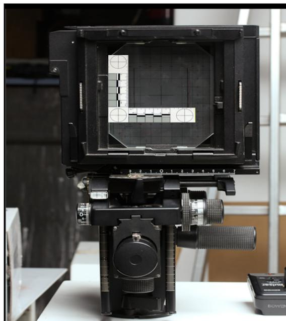
**Figura II.16** - Corpo de máquina aberto permitindo a visualização da grelha de orientação. Enquadramento e minimização de distorsão pelo visor da máquina.
