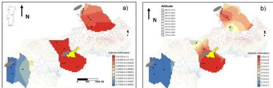
Figura 2. Mapas de iso-probabilidade do teor de As nas águas exceder K12 (0,004 mg/L):
