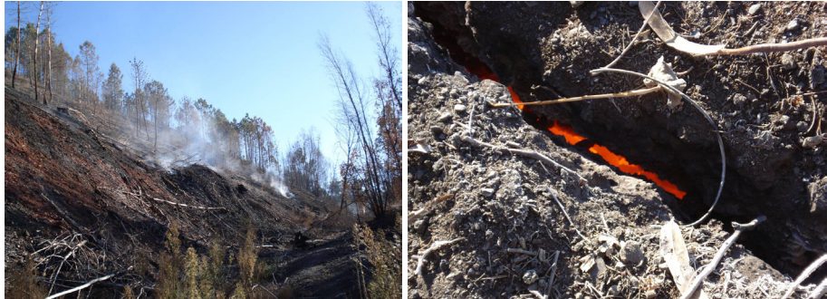
Figura 1 - A - Vista parcial da vertente da escombreira da mina de S. Vicente em combustão lenta; B - Fendas no solo que evidenciam a combustão interna da escombreira. (Fotografias de Cármen Ferreira, Out.2007).
