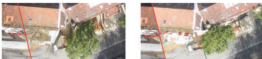
Figura 18 - Pormenor do ortomosaico, criado por junção de áreas das ortofotos A e D, e a hipótese de este resultar da junção de áreas das ortofotos A e E
