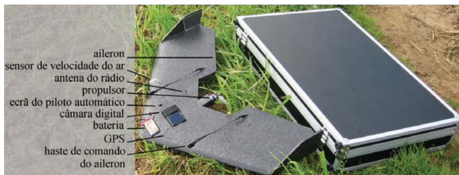
Figura 1 - SenseFly Swinglet CAM e mala de transporte
