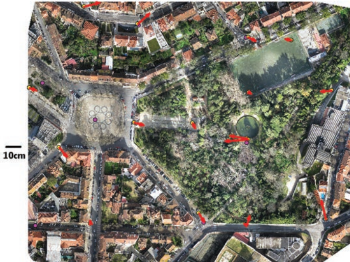
Figura 19 - Ortomosaico com indicação da localização dos pontos fotogramétricos (magenta), dos pontos de controlo (amarelo) e diferenças entre coordenadas planimétricas do ortomosaico e GPS (setas a vermelho)
