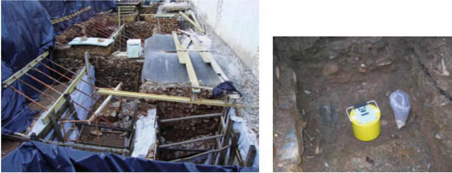
Fig. 3 – Aspetto geral da zona estudada, sendo evidente a forte compartimentação do terreno resultante da escavação entre os muros, e execução de uma leitura com o GeoGauge.
