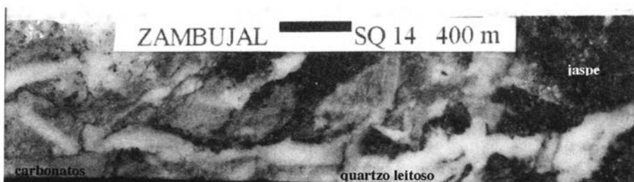
Fig. 3 – Amostra da Unidade de jaspes e carbonatos. Sondagem SQ 14 aos 400,0 m; jazigo do Zambujal. Escala gráfica de 1 cm.
